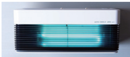
紫外線照射装置「AERO SHIELD」 高さ2.1m以上の天井面に紫外線層をつくることで、生活空間に影響を及ぼすことなく、自然対流で通過する浮遊菌を不活化
