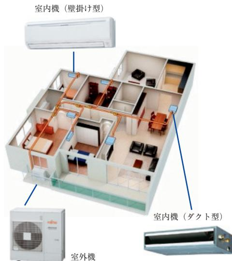
1台の室外機に複数の室内機を接続できるマルチエアコンは、室外機の設置スペースが限られた集合住宅に最適
