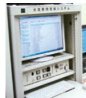
緊急地震速報等の情報を人工衛星を介して受信し、市民の方々へ瞬時に伝達する全国瞬時警報システム（J-ALERT）
